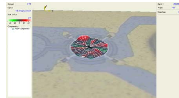
ディスク共振子フィルタの共 振モード観察 (293 MHz) (Polytec 社 高周波レーザドッ プラ振動計によるイメージング)
