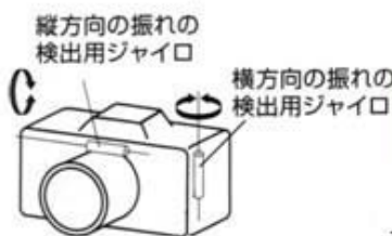
デジカメ用ジャイロ (手振補正)
