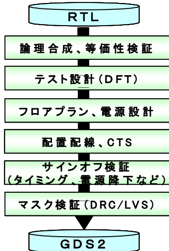
図表 3-15 物理設計の工程分割と各工程の工数分布調査結果
