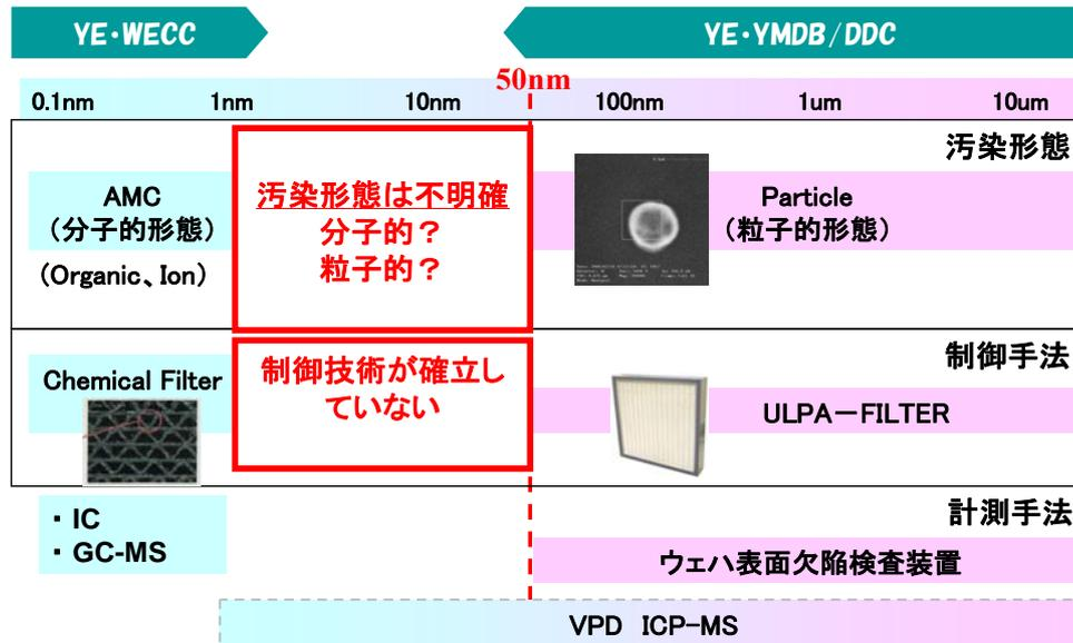
図表 14-13 パーティクルの汚染形態と制御手法と計測方法 資料提供：東京エレクトロン株式会社
