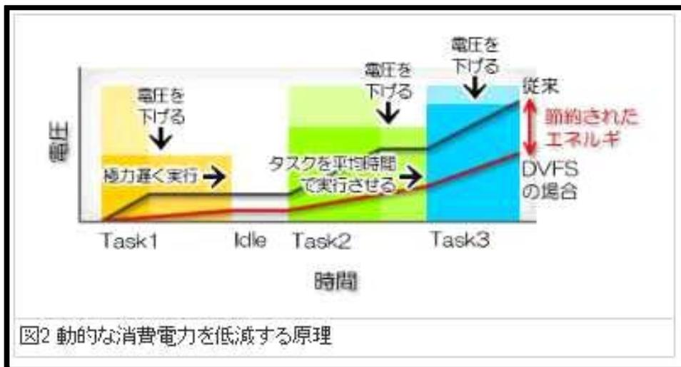
図2 動的な消費電力を低減する原理
