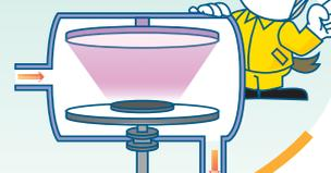
ウェハを高温の酸化炉(1000~1200℃)の中に入れ, 表面に酸化シリコン膜を形成させます。その上に感光膜(フォトレジスト)を薄く塗布します。
