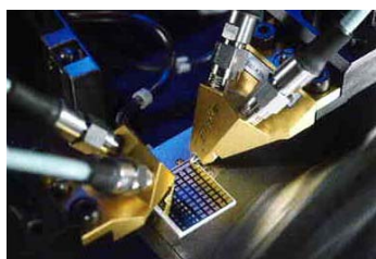
対策①: 数十GHz対応 コプレーナプローブ
