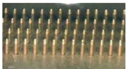
対策②: 多ピン対応垂直プローブ
